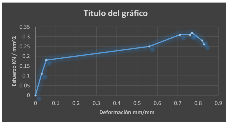
Figura 5. Gráfica de la curva E-D trazada con el promedio de los valores obtenidos de tres probetas ensayadas
